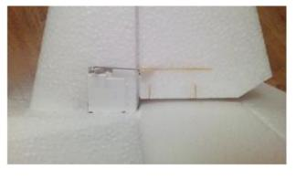
Seitenleitwerk mit PU Leim in der Mitte und CA am Umfang an den Rumpf. Das Seitenleitwerk muss senkrecht zum Höhenleitwerk und parallel zur Rumpf-Mittellinie sein.
