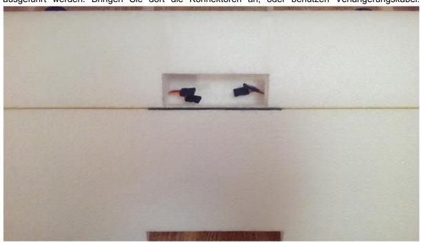
Schneiden Sie die zwei Befestigungsplatten parallel in die Mitte der Tragflächen-Vorderkante, 90 mm voneinander. Markieren Sie die Stellen dem Gegenteil nach. →
