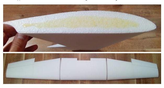
Schneiden Sie in die untere Seite der Tragfläche, 90 mm von der Vorderkannte in der Flügelmitte, den aus der GFK Platte ausgefrästen Flügelholm ein. Der untere GFK Holm hat eine V-Form und etwa in der Mitte eine Öffnung für das Hauptfahrwerk. Die Holme werden mit der CFK Rechteckstab 5x0,6 mm bis zum jeweiligem Flügelende verlängert, dabei sollen sich der GFK Holm und CFK Rechteckstab ca. 65 mm überlappen. Verbinden Sie die beiden Holme in der Mitte mit einem Rest des CFK Rechteckstabes.
