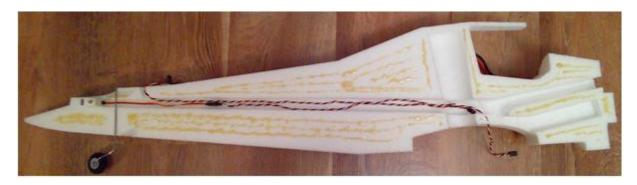
Kleben Sie die beiden Teile des Höhenleitwerkes zusammen und verstärken es in ganzer Länge von einer Seite mit dem CFK Rechteckstab 5x0,6 mm. Schneiden Sie in das Höhenruder in der Ebene des Servohebels das Ruderhorn ein (1 von 4 Stuck – andere Form als die Klappenscharniere). Kleben Sie das Höhenleitwerk mit PU Leim an. Kontrollieren Sie, ob das Höhenleitwerk senkrecht zum Rumpf ist, bevor der Leim
