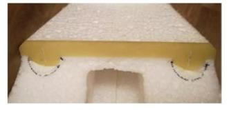
Die Sperrholzplatte sollte möglichst parallel zu der GFK Platte am Flügel (und somit der Unterseite des Flügelprofils) mit PU Leim im Rumpf verklebt werden.
