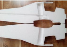
Legen Sie die schon an die Servos angeschlossenen Verlängerungskabel in der vorbereiteten Rille im Rumpf. Kleben Sie beide Rumpfhälften mit PU Leim + CA zusammen, genauso wie die Tragflächen (PU Leim 10-15 mm vor den Kanten nicht auftragen). Den PU Leim ca. 10-15 mm um den Spornfahrwerksdraht <u>nicht</u> auftragen. Nach dem Ausrichten beider Hälften diese mit Stecknadeln sichern und mit dünnflüssigen CA den kompletten Umfang kleben.
